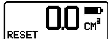
Der Fettmesser wird abgeschaltet, indem der linke Knopf 2 sek lang gedrückt wird.
