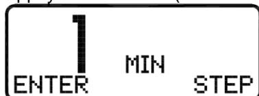
Appuyer sur STEP (le bouton de droite) pour passer au délai suivant ou en mode STAND BY.
