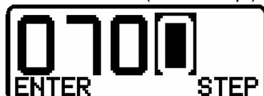
Die markierte Ziffer kann durch Drücken von STEP (rechter Knopf) erhöht werden.
