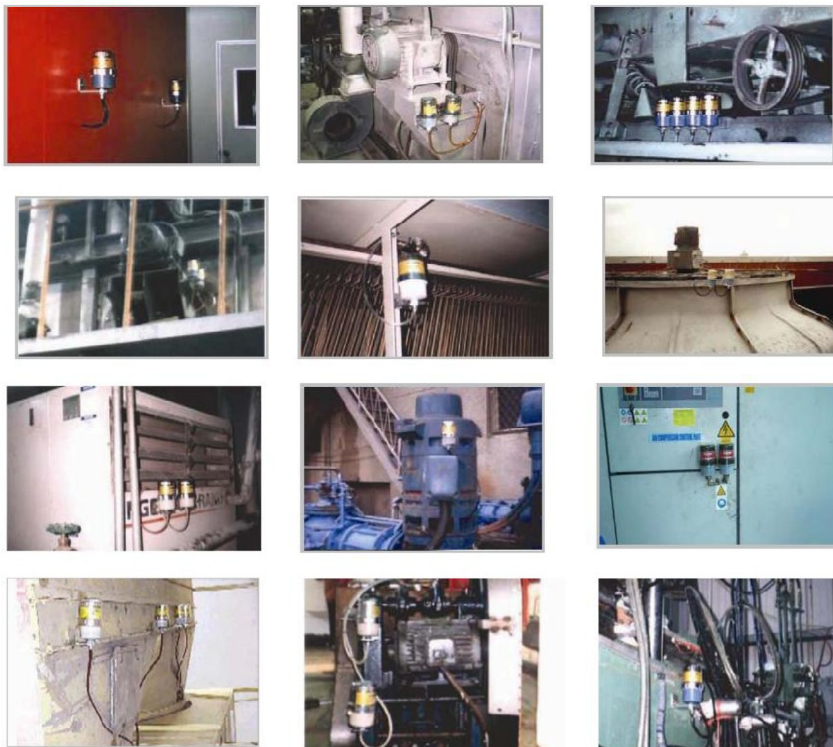
Exempel på smörjenheter monterade på avstånd från smörjpunkten.
