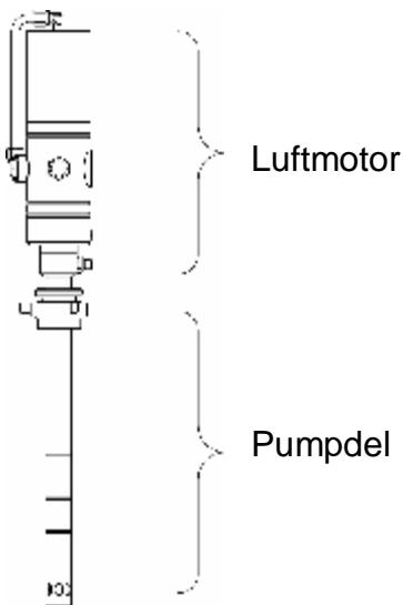
Kolvdiametern på luftmotorn är 75mm. Luftmotorn består av en luftcylinder med kolv och en ventil. Ventilen har till uppgift att växelvis leda tryckluften till översidan och växelvis till undersidan av kolven. På detta sätt erhålls en fram och återgående rörelse hos luftmotorns pumpstång.
